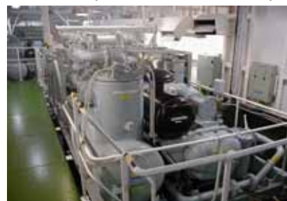
写真-1 可搬式コンプレッサー概観 （20feet コンテナ型）
