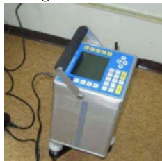
Microgravimeter
