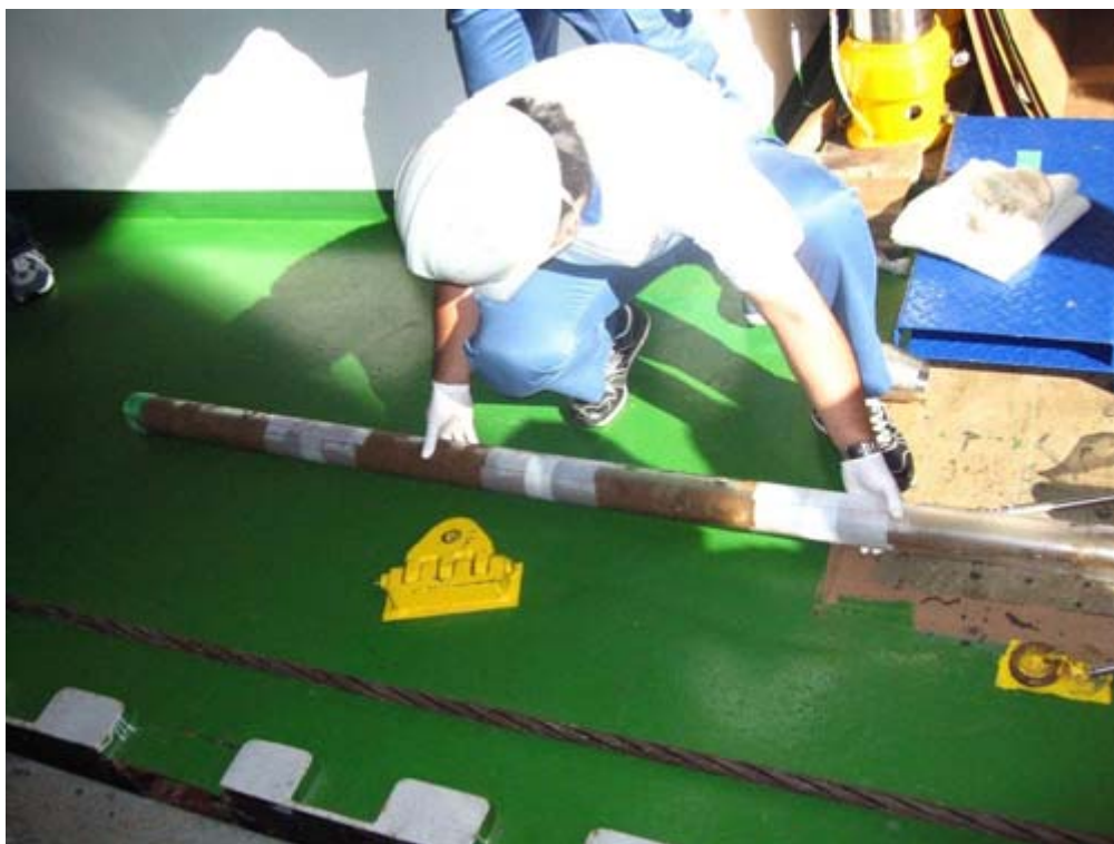
マリアナ海溝水深 10,350m の海底より採取された約 1.6m の海底堆積物
