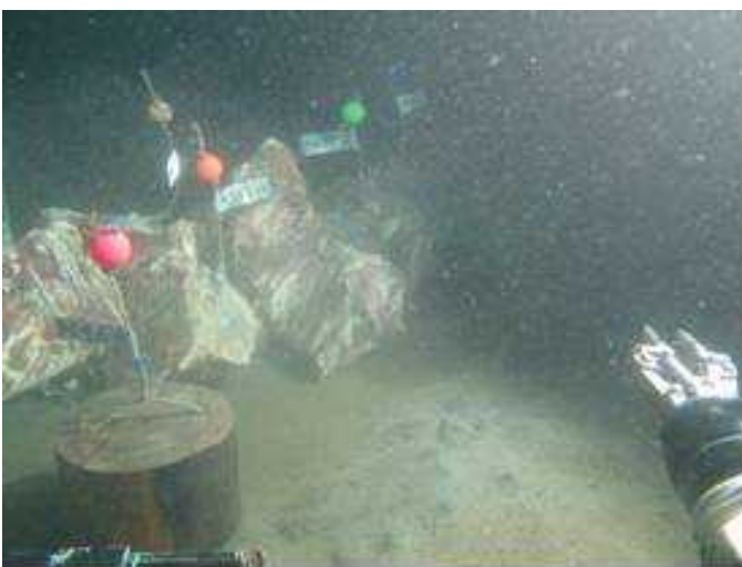
図3 . サツマハオリムシサイトに設置する準備ができた鯨骨と丸太。この後、ADCPの測定結果から、ハオリサイトの上流と下流に分散設置した。
