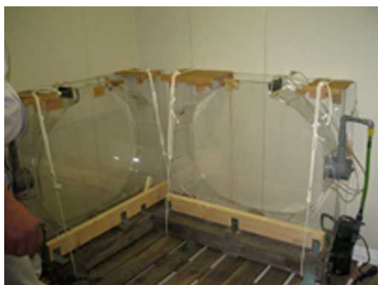
Fig. 2. コンテナラボ低温室内に設置したクライゼル水槽
