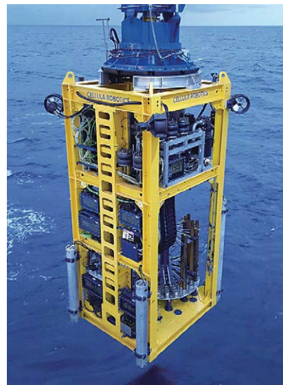
図5.海底設置型掘削装置 運用最大水深3,000m、海底下30m掘削(コア径61.1mm)
