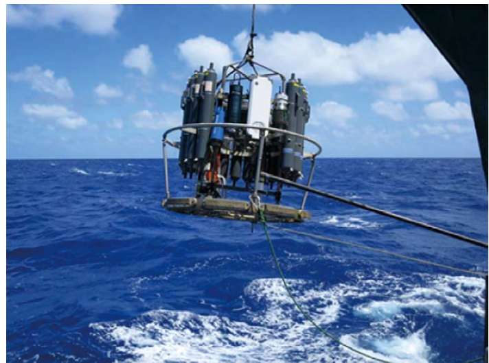
図6.ハワイ沖で行われたフェーズ4 (最終観測試験) の様子。 決勝進出した5チームのpHセンサを搭載した採水器が海中投入され、鉛直観測を実施した。
