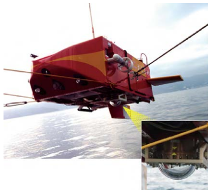
図8.3Dレーザースキャナーを搭載した「おとひめ」。システムは耐圧容器に収納され、レーザーはガラスウィンドウを通して海中を走査する。
