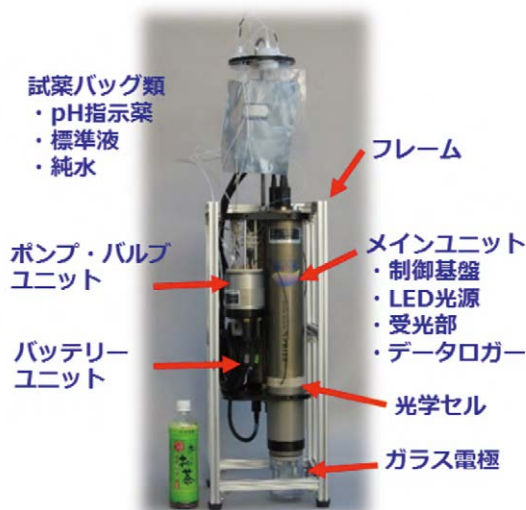
図5.ハイブリッドpHセンサ (HpHS) 比色法と電極法のハイブリッドpHセンサ
