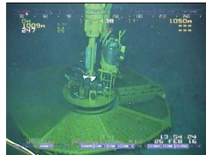
図1. 熱水活動の長期観測のためのモニタリング装置と噴出孔の様子
