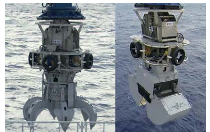
図8.パワーグラブ(6本爪型、シェル型) 運用最大水深6,000m、バケット容量1m 3
