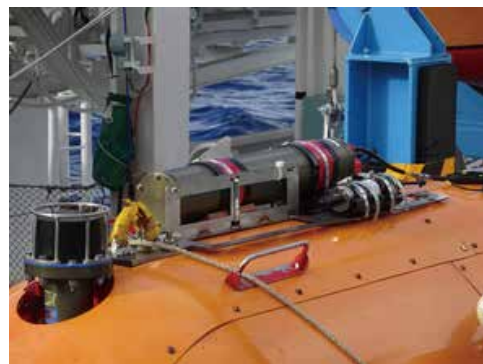
図：小型電位計を搭載したAUV「じんべい」 Figure : AUV Jinbei equipped with a compact electrometer
