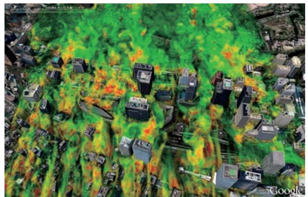
図4：MSSGを用いて、東京都丸の内周辺の2005年8月5日15:00の大気の状態を5mの計算格子でシミュレーションした3次元温度分布
