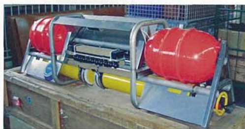
図4 合成開口ソナー試作1号機 全長1.5m 空中重量約60kg 水中重量0kg
