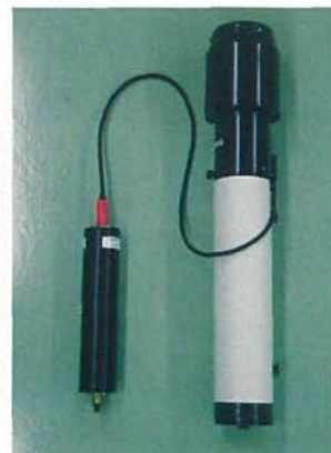
実用化した気象センサユニットのサンプル 図は雨量計の例(プローブのみ外国製)
