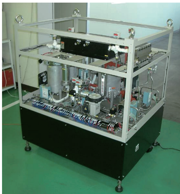
写真●水素・酸素回収機構を備えた燃料電池システム
