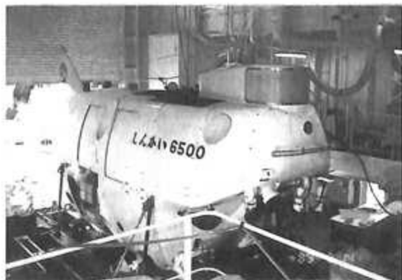
写真1 母船「よこすか」格納庫内で整備中の「しんかい6500」
