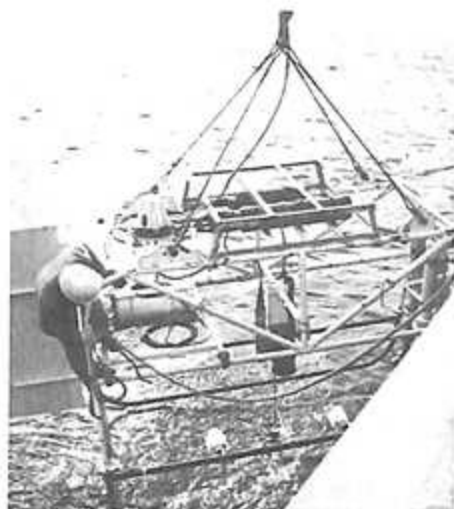
写真-1(2) カメラや音響トランスポンダを装備した初期の曳航装置を点検しているところ
