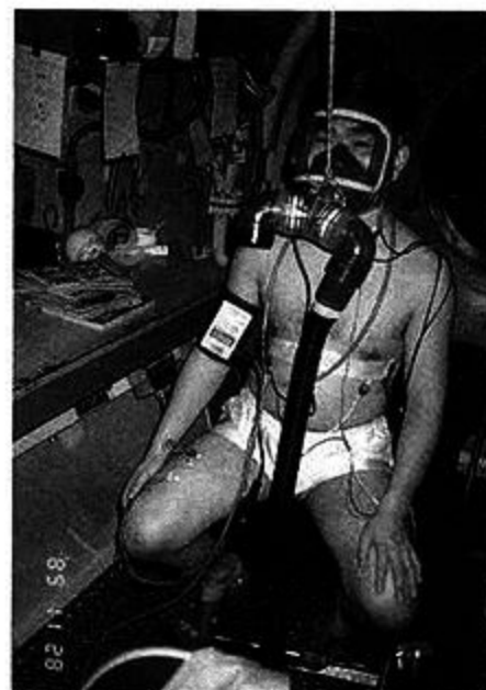
図-4 実験計測中のダイバー (潜水シミュレータ, 31 気圧)
