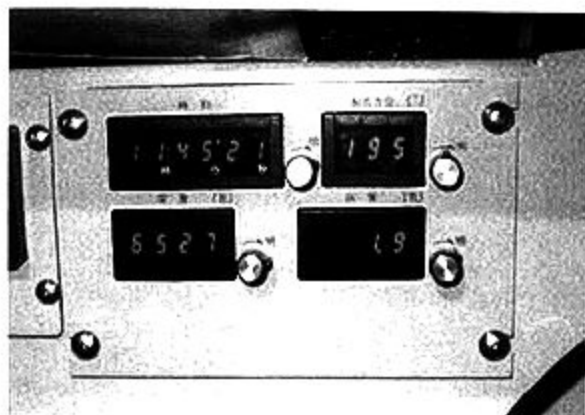
写真-5 深度計による6,527mの数値表示
