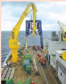
図3 ピストンコアラーによる採泥
