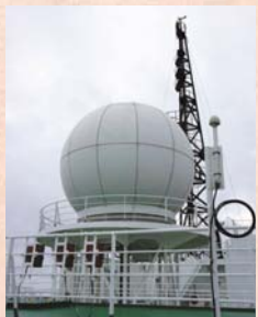
図2 ドップラーレーダードーム
