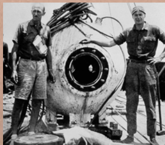
1934年 潜水球「バチスフェア」深度923mに到達。「バチスフェア」は生物学者ウィリアム・ビービ(左)と技術者オーティス・パートン(右)が製作した。 ©Ralph White/CORBIS/amanaimages
