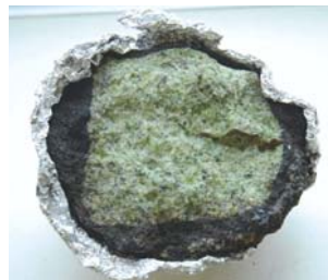
研究対象であるマントルかんらん岩。圧力から解放されてぼろぼろ崩れやすくなっているので、地上での採取にはアルミホイルと瞬間接着剤が必須だという。
