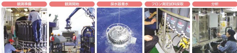
図5 CTD採水観測 採水器や各種センサーをセット 採水器を吊り上げ、海に投入 周りに36本の採水器が取り付けられている。海底まで下ろし、海水を採取して回収 回収した採水器から分析用の試料を採取 船上の分析室でフロン濃度を測定
