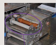
水と一緒に入ってきたプランクトンをメッシュの袋でとらえて巻き取る。10マイル分ごとに線が引かれているので、後でどの場所で採取されたのか分かるしくみ。
