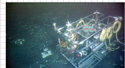
海底地震計などを搭載した、初島沖「深海底総合観測ステーション」。
