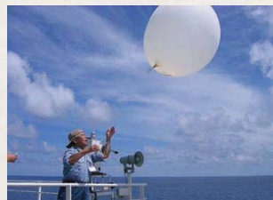
「みらい」船上からラジオゾンデを放球し、上空大気の観測を行う。
