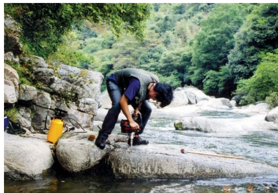
岐阜県白川村でのサンプリング風景。岩石をハンマーで割れないような場所では、エンジンドリルを使って石を振り抜いて採取する。「山に入って調査をするのが好き。露頭を見て考え、サンプルを持ち帰って分析して、また考える。そして再び山に行き、露頭を見て確かめる。その繰り返しです」
