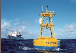
トライトンプイ 海底におもりで係留され、海面や海中の水温などを観測。現在、トライトンなどの係留ブイが太平洋熱帯域で77基、インド洋熱帯域で30基、観測を行っている
