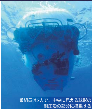
潜航する有人潜水調査船「しんかい2000」。全長9.3m、幅3.0m、高さ2.9m、空中重量約24トン
