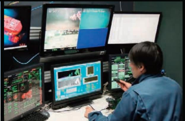
海中3Dレーザーキャナーを用いたマンビュレータ操作支援システムの試験も実施した。マンビュレータを操作するとき、海中3Dレーザーキャナーによって得られた3D画像や光強度画像、距離画像を用いることで、カメラ画像には写らない遠方の目標を把握することができる
