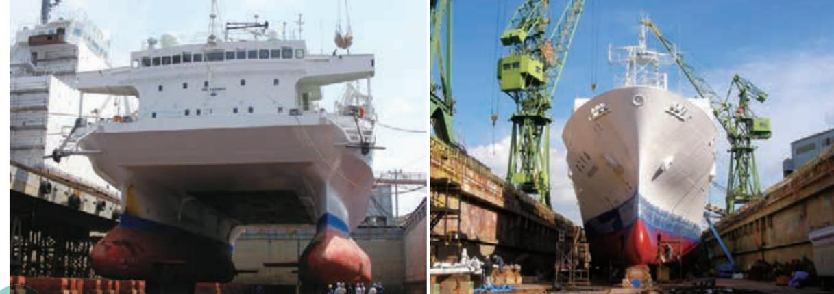
図3 「かいよう」と「よこすか」の定期検査工事の様子 ドライドックに入って、船底および船底機器の状態の検査と修繕工事を行っているところ
