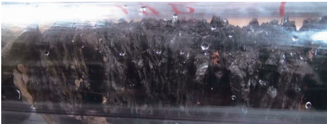
「ちきゅう」により採取した、東北地方太平洋沖地震ですべったと考えられる日本海溝プレート境界の断層試料
