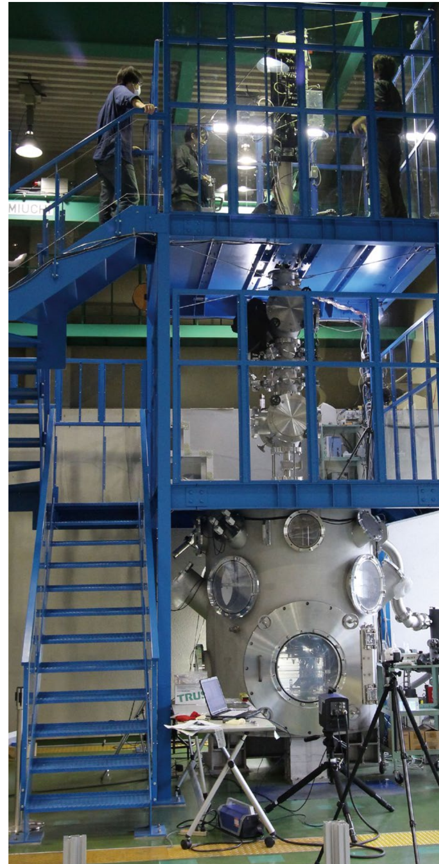
JAXA宇宙科学研究所にある垂直型二段式軽ガス銃設備。一番下の真空チェンバー内部に模擬海水を入れて密封した水槽を入れ、装置上部から炭素質コンドライト隕石製の弾丸を、秒速5～6kmの超高速で水中に撃ち込む。小天体が海洋に衝突したときに進む海中の物理化学現象を再現し、観測する。
