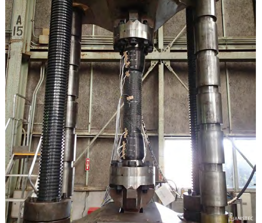
CFRPライザー模型の引張試験の様子
