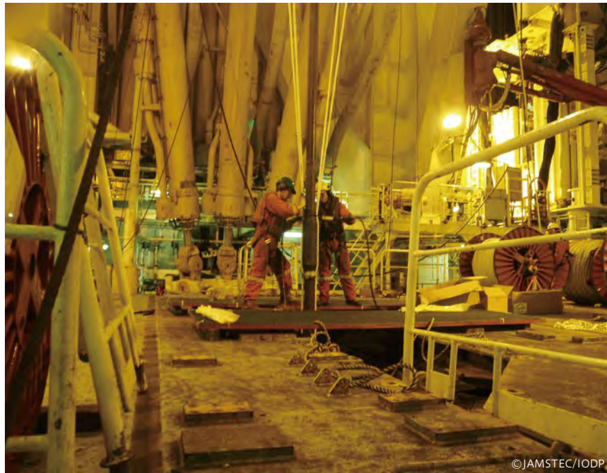
ドリルパイプに振動防止のためのロープを取り付けている様子
