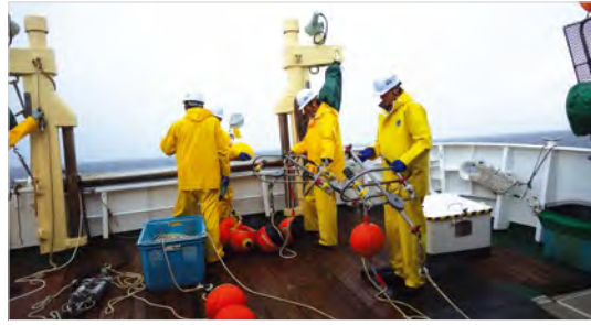
図3：北海道大学水産学部附属練習船「うしお丸」船上での係留系の投入風景
