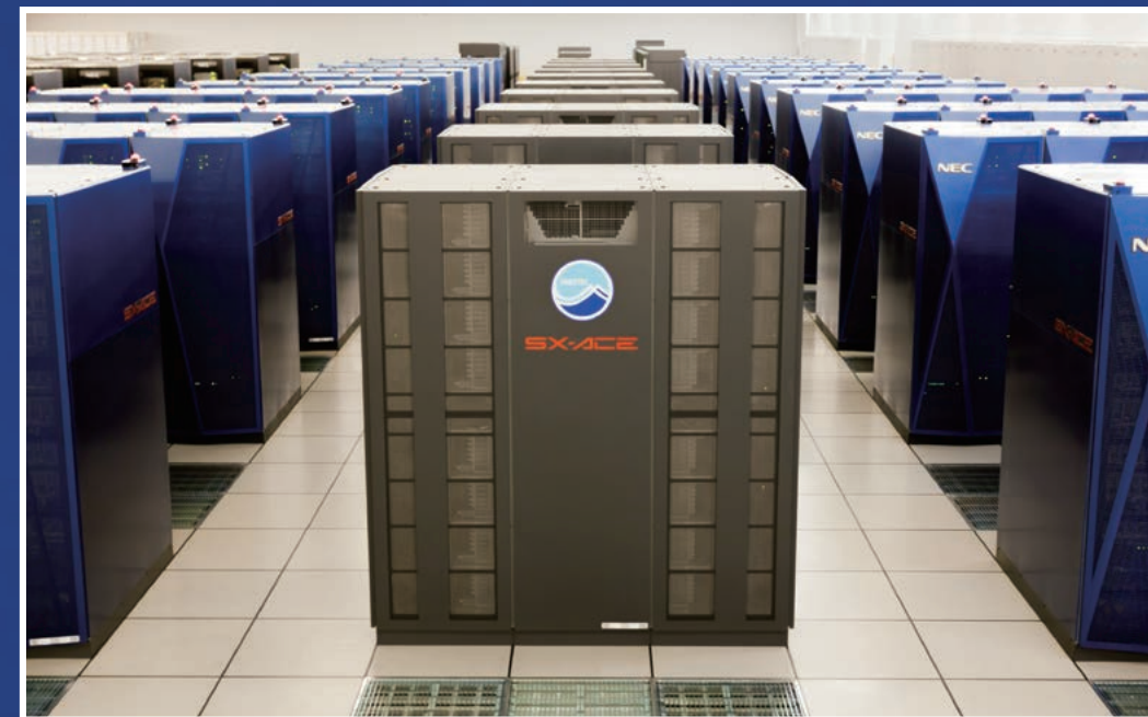
スーパーコンピュータ「地球シミュレータ」。世界最大規模の分散メモリー型ベクトル並列計算機で、地球温暖化予測、地球内部変動研究などの海洋地球科学分野をはじめさまざまな分野の研究に利用されている。
