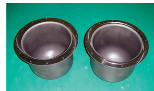
ロストワックス精密鑄造法でつくった耐圧容器の試作品。内側の空洞部分の直径は22cm。
