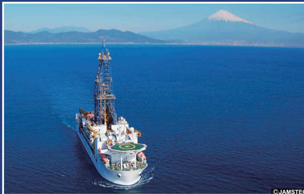
地球深部探査船「ちきゅう」。レーザー掘削技術を初めて科学研究用に導入し、世界最高の掘削能力（海底下7,000m）を持つ科学掘削船。国際深海科学掘削計画（IODP）の主力船として、巨大地震発生の仕組み、生命の起源、将来の地球規模の環境変動、新しい海底資源の解明など、人類の未来を開くさまざまな成果を上げることを目指している。
