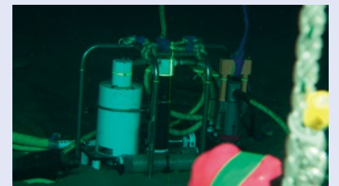
移動式水圧校正装置から水平にレーザーを照射しDONET水圧計と水深を合わせて、真の水圧値を測る。
