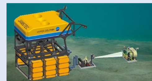
DONET水圧計の校正実験 無人潜水機によりDONET水圧計の横に移動式水圧校正装置を設置し、高さ・姿勢調整を行った後、水圧計測を行う。
