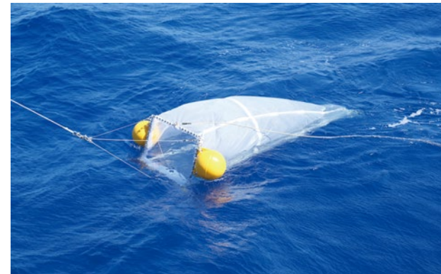
ニューストンネットを使ったマイクロプラスチックの採取の例。写真は2019年8～9月の深海潜水調査船支援母船「よこすか」の航海で行われた採取の様子である。このときの航海では、有人潜水調査船「しんかい6500」による深海でのマイクロプラスチック調査が行われた。 写真提供：中嶋亮太/JAMSTEC
