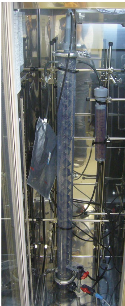
下降流懸垂型スポンジリアクター。なかにスポンジがつるされている。
