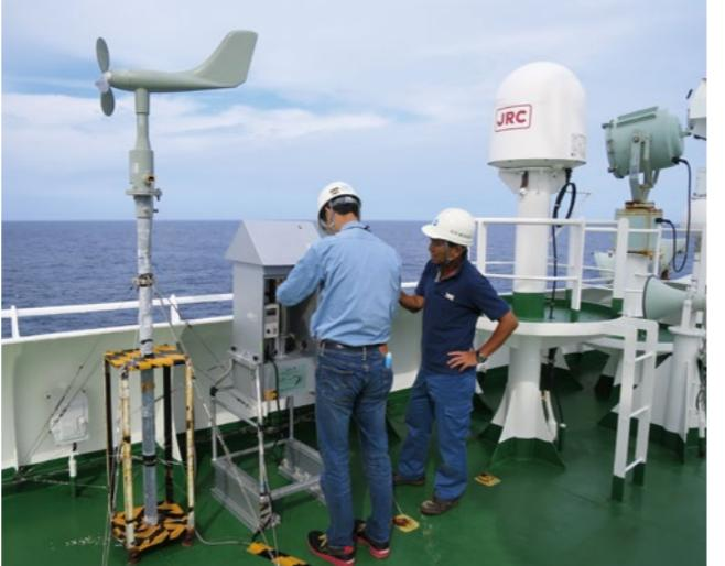
コンパスデッキと呼ばれる船の屋上に設置されたエアサンプラーのフィルターを交換する竹谷さん(左)。自船の煙を捕集してしまわないように、船の前方からの風の場合のみポンプの吸引を行うように風向風速計と連動する仕組みになっている。
