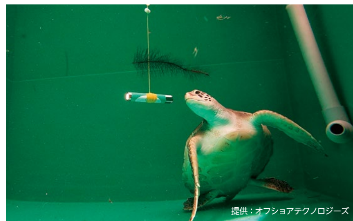
水槽でテスト中のライト付きカメラ
