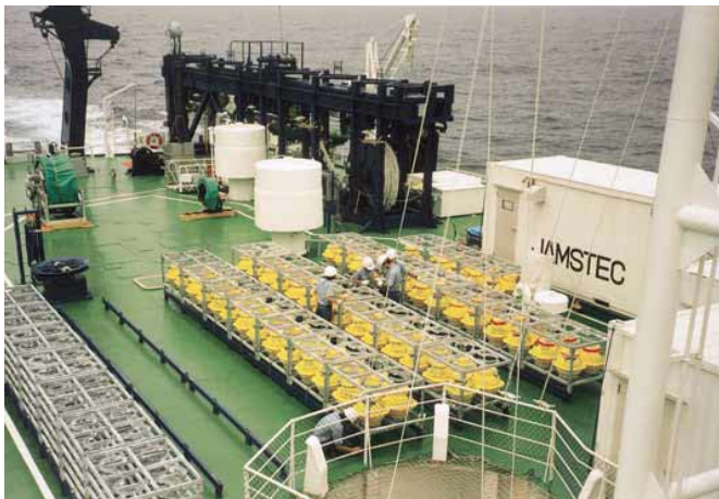
探査前、海洋調査船「かいよう」の船上に並べられた海底地震計
