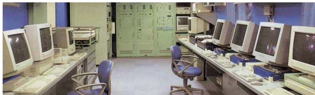
調査指揮室。観測等で得られたデータや情報は、船内LANで共有化され、処理検討をスムーズに行うことができる。
