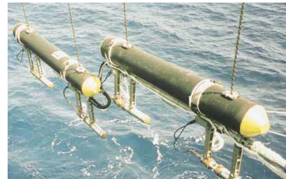
圧搾空気を使って人工地震を生むエアガン
