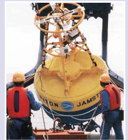
観測データは人工衛星を通して直ちに研究者のもとへ送られる。
