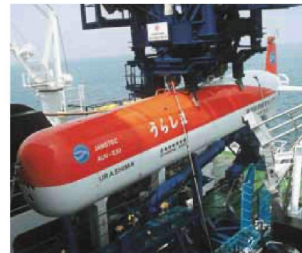
潜航試験では、深度約300mで6.5kmを連続航行した
