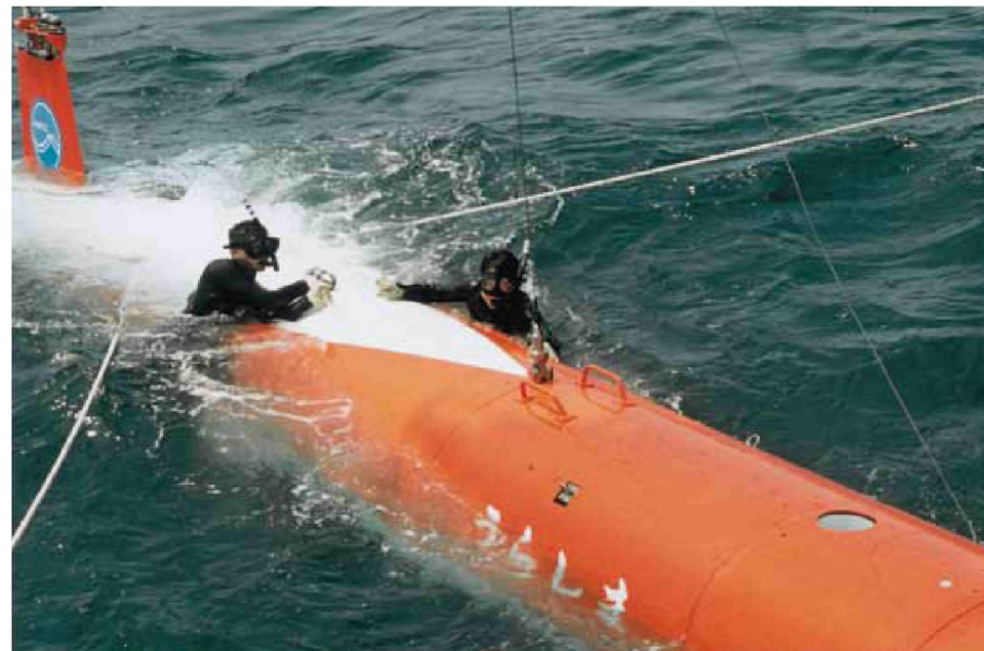
着水揚収試験ではスイマーがサポート
