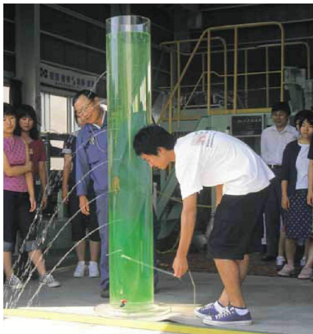
水の飛ぶ勢いで、水圧を“見る”水柱実験
