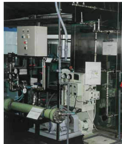
研究所内の淡水化試験装置。ここで深層水の塩分が抜かれる
