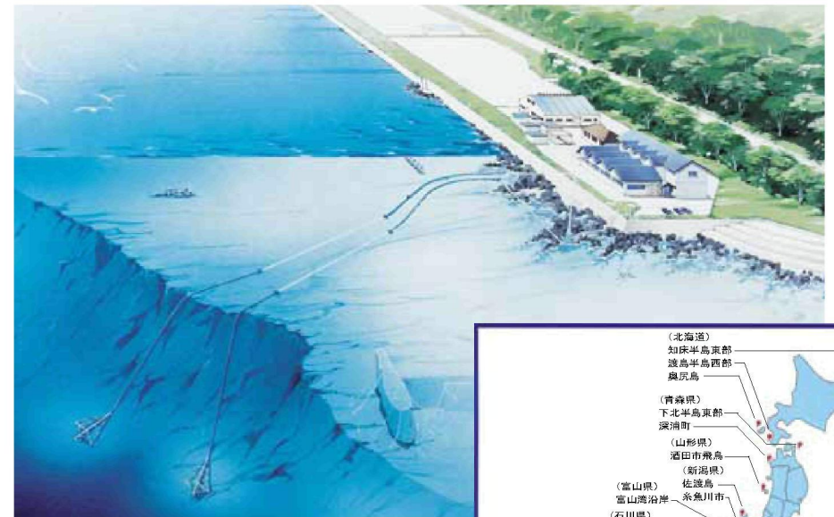
1989年、高知県室戸に整備されたわが国初の深層水研究施設。中央の2本の取水パイプで深層水を探取する
