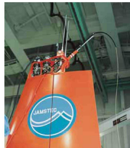
UROVモードでは直径1mmの光ファイバーケーブルで、母船と通信する
