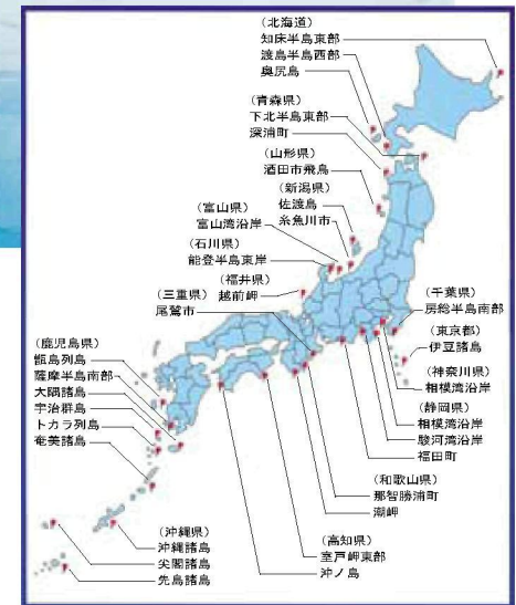
わが国において深層水取水が可能な地域 (海岸線より水平距離5km以内で、水深が200mに達する地域)
