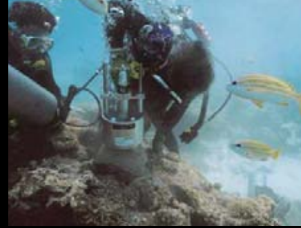
センターで開発された「マイクロボーリングマシン」。サンゴを殺さずにコアサンプルを取り出すことができる
