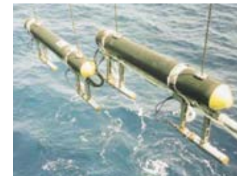
エアガンで人工地震をおこし地殻構造を探索
