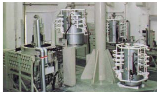
深海微生物実験システムの分離装置と培養槽
