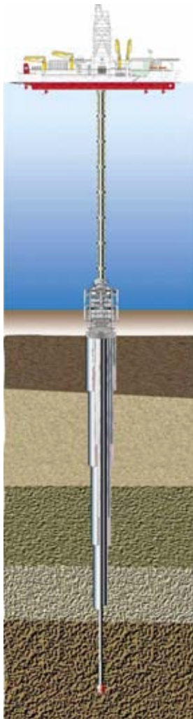
ライザー掘削システムでさらに深部への掘削が可能となる
