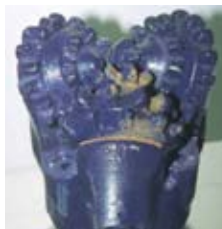
ドリルパイプの先端に取り付けられるドリルビット
