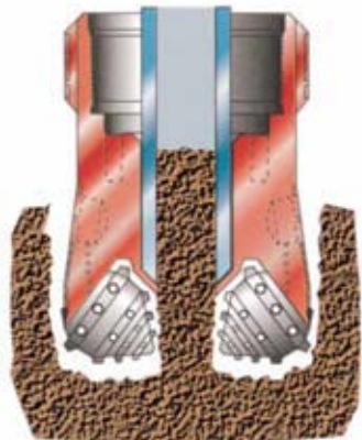
先端のドリルビットが回転し地層を削る
