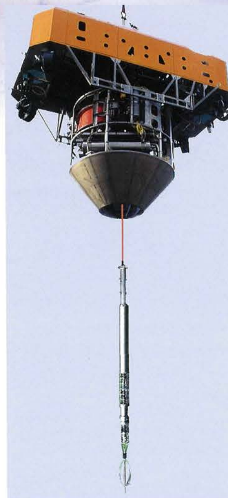
▼ビークル・観測ステーション・センサーで構成される「べんけい」。6,000mの深海底に穿かれた孔内に、正確にセンサーを吊り降ろすことができます
