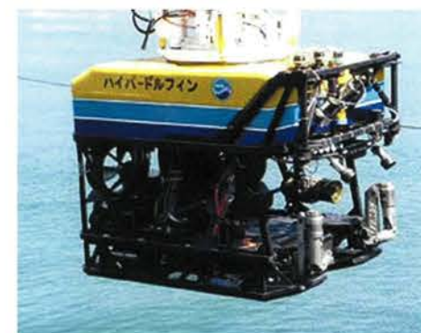
▲マニピュレータの間に見える筒状のものがハイビジョンカメラ。高解像度の映像が撮影可能です
