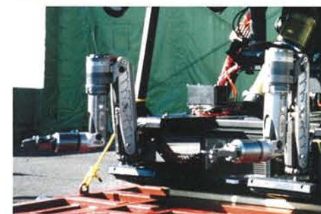
▲重作業が行える高性能のマニピュレータを搭載。映像による観察だけでなく設置作業にも対応します
