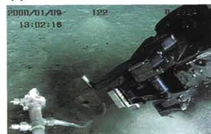
▲高い性能を発揮するマニピュレータでの採取作業。各種観測器設置作業も行えます
