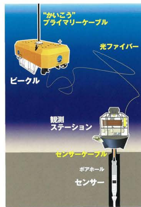
▼ビークル・観測ステーション・センサーで構成される「べんけい」。6,000mの深海底に穿かれた孔内に、正確にセンサーを吊り降ろすことができます
