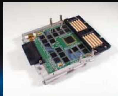
主記憶ボード。大きさは125×147mm。メモリのタイプはFPLRAMといって、アクセススピードが非常に速いのが特徴。1枚の記憶容量は512メガバイト。
