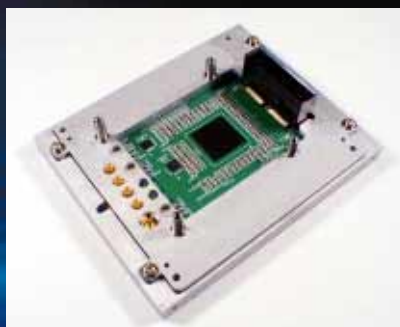
「地球シミュレータ」のプロセッサボード。大きさは115×139mm。中心部にある2×2cmの黒いものが1チップ・ベクトルプロセッサ。これ1枚で8ギガバイトの演算処理性能を持つ。
