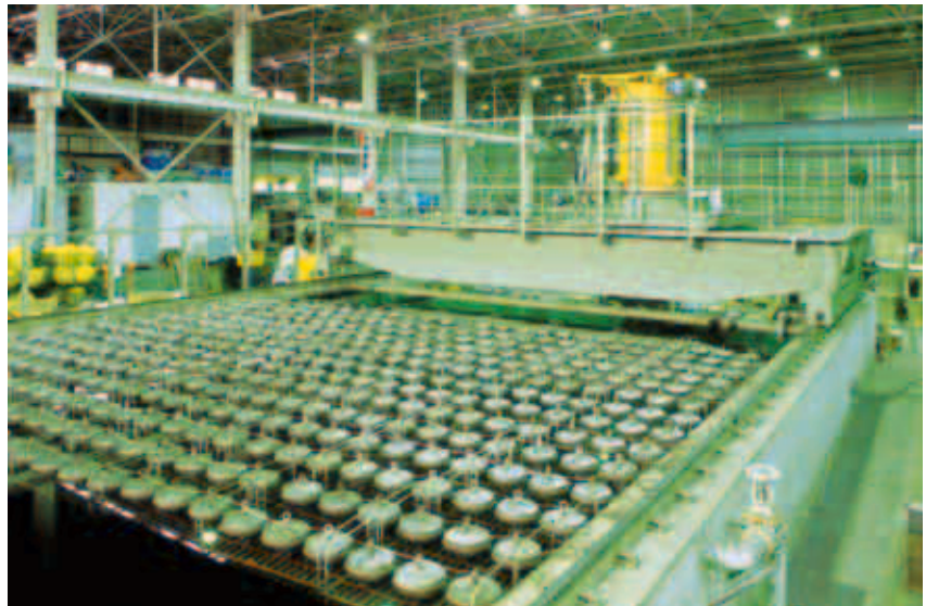
水中で音響信号を送受信する送受波器の感度と指向性の測定などが行える超音波水槽。
