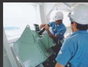
XBTなどの投下式観測機器を海に投入
