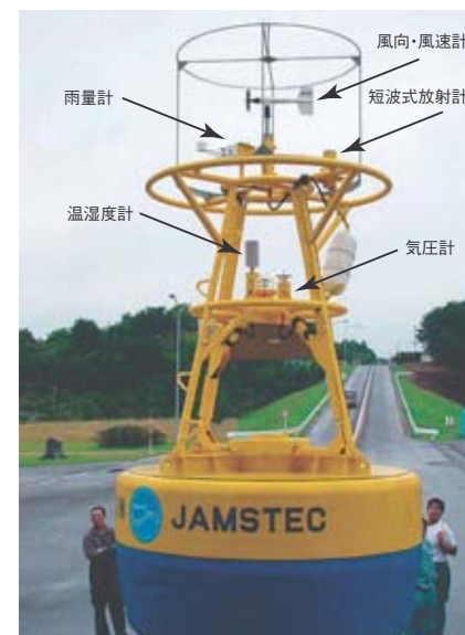
むつ研究所で整備中のトライトンブイ。 気象観測のセンサーも充実している
