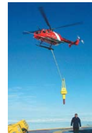
ヘリでブイ本体を吊り上げる。重さは約250kg
