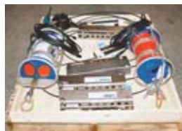
J-CADで使用されている吊り下げ式 ADCP
