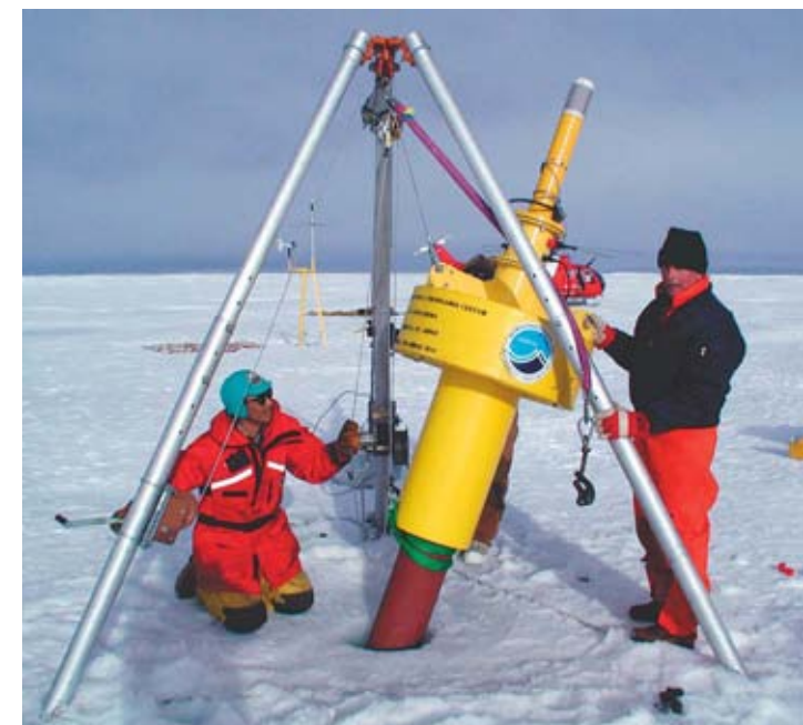
厚さ2~3mの海水に穴を開けてJ-CADを設置する
