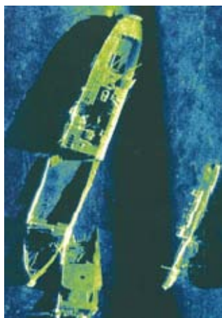
写真1 サイドスキャンソナーで得られた音響画像の例
