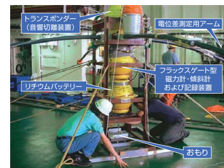
海底電位差磁力計（OBEM）の構成
