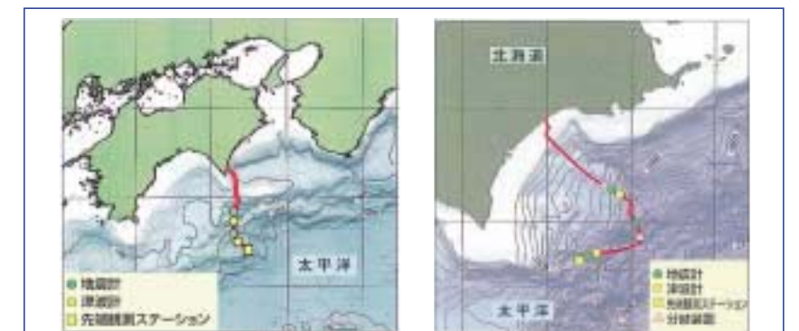
室戸岬沖（左）、釧路・十勝沖（右）観測システムの観測装置配置図
