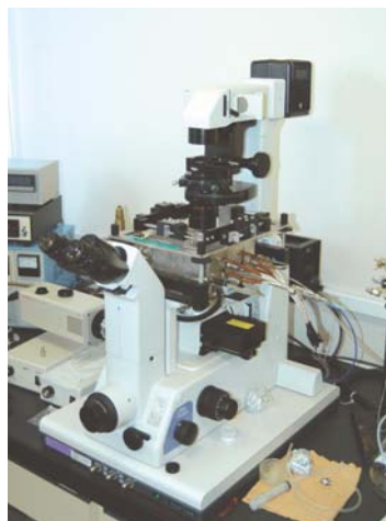
超臨界水研究のために新たに開発された高温・高圧光学顕微鏡。
