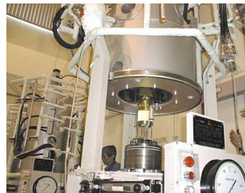
深海環境の圧力と温度を保持したまま深海微生物を採取し、分離・培養が行える深海微生物実験システム。左は培養槽、右は希釈装置。
