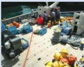
観測作業甲板。左舷側にウインチ類を配置。
