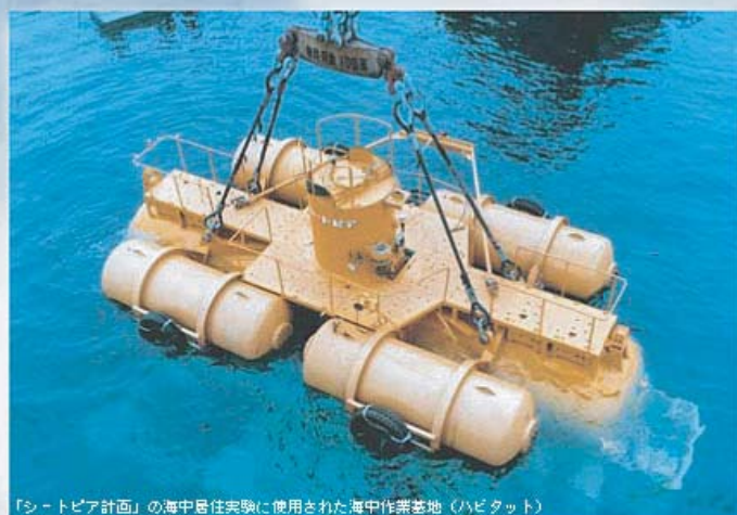
「シートピア計画」の海中居住実験に使用された海中作業基地（ハビタット）
