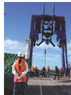
グラビティコアラの回収作業
