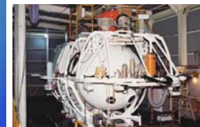
「しんかい2000」のフレームには、当時は貴重だった純チタンが使用されている。
