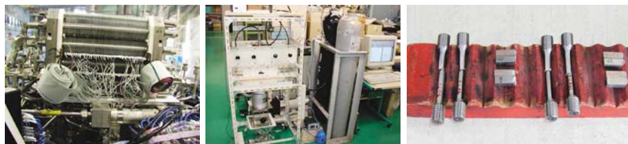
リチウムイオン電池に換えて「うらしま」に搭載された燃料電池。航続距離も格段に向上。燃料電池の燃料となる酸素を安全かつ効率的に貯蔵するナノ・カーボン材の性能試験。優れた耐水圧容器をつくるための素材開発が進められている。写真は新チタン合金の試料。
