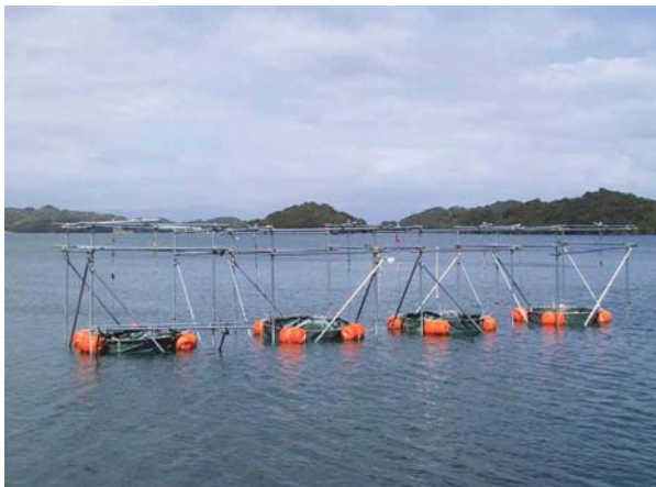
メソコスム実験。海を直径2m、長さ6mの筒状のバッグで4ヶ所を囲った。メソコスム上部はパイプに支えられ水面から40cm高くなっているので海水の出入りはない。下部はバックに接続された直径2m、高さ15cmの金物が海底の泥に突き刺さっている。
