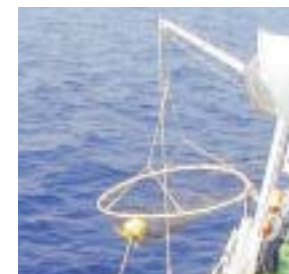
浮上した地震計を回収。ラジオビーコンとフラッシャーが浮上を知らせる
