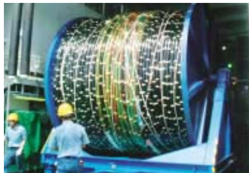
巨大なウィンチのリールに巻き取られたストリーマーケーブル。長さは約5,000m。ケーブル内にハイドロフォンが組み込まれている
