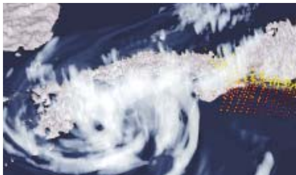
新たに開発されたプログラムで、台風とそれに伴って山越える湿った空気を再現したシミュレーション画像。渦を巻く雲が台風（左）で、球（右）は空気の温度（赤いほど高く、黄色は低いことを示す）と水分（球が大きいほど水分が多い）を表している
