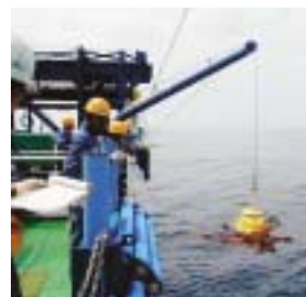
探査海域に投入される海底地震計。海面から自由落下させて海底に設置する
