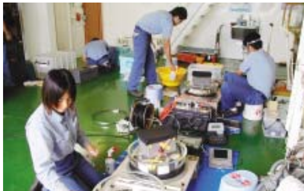
地震計センサ、レコーダー、電源がセットされたガラス球(写真)を開けてデータを取り出す
