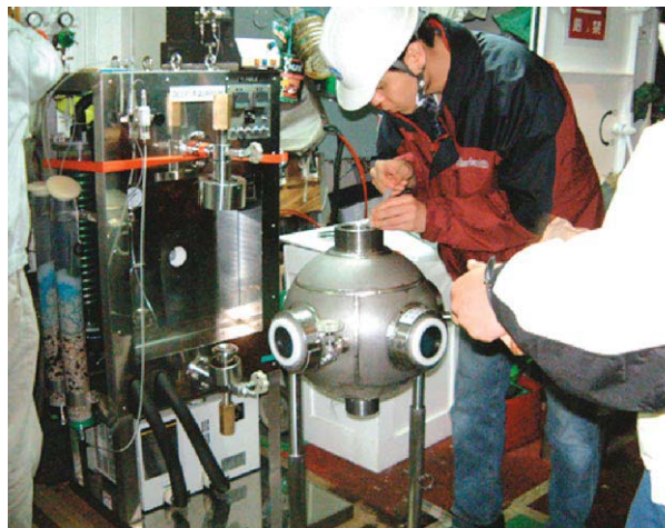
深海から生物を持ち帰るための水槽「ディープアクアリウム」は、直径約30cmのステンレス球
