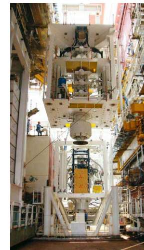
多数の安全弁を備える噴出防止装置（BOP）が掘削を行う海底に設置される
