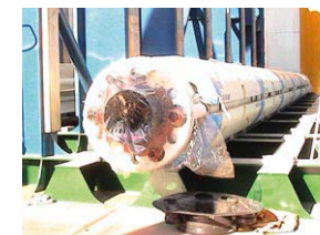
「ちきゅう」と海底を結ぶライザーパイプ。その直径は122cm、1本の長さは27m。
