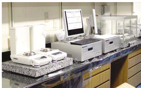
現在開発中の電子天秤。2台の天秤を並列して、既知の分銅と比較することにより、振動の影響を除外して試料の重さを測定する
