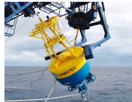
海上に設置されるトライトンブイ。ブイは1年ごとに回収し、整備されたものと交換される
