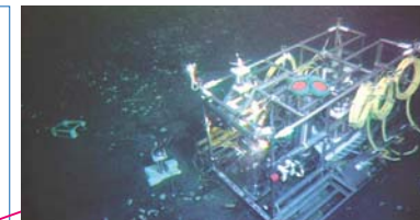
初島沖「深海底総合観測ステーション」の位置 ステーションは初島南東沖約7km、水深1,175mの海底に設置されており、近くにはシロウリガイなど化学合成生物のコロニーがある。2000年の更新時に、海中でも絶縁が保たれ、無人探査機により着脱可能なコネクタが搭載された
