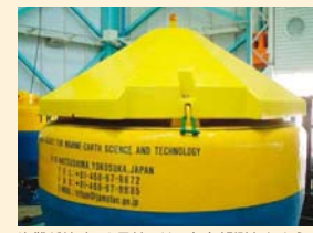
盗難が続く16号基では、気象観測をあきらめ、カバーを追加して格納部を守ろうとした
