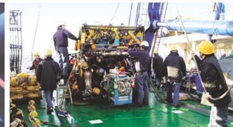
船上での海底電位差磁力計の設置準備作業 天候の変化をうかがいながら慎重に作業を進める
