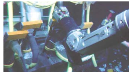
水中コネクタの接続 「ハイパードルフィン」のマニピュレータは操作性が高いものの、人間の手のように細かい作業は不可能なため、あらかじめコネクタ部分をマニピュレータでの接続が容易な構造にしている
