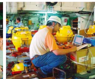
船上で海底地震計の設置前の整備を行う
