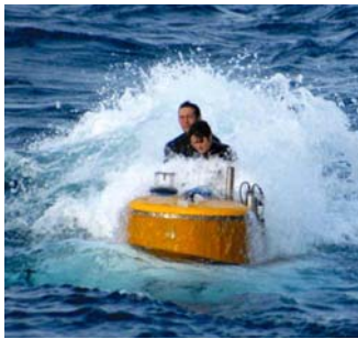
揚収時、潜水船と母船をつなぐロープをとりつけるためにダイバーが活躍する。このときは波が荒かった
