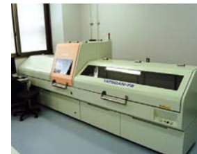
XRFコアローガー。X線で非破壊のままコアに含まれる多元素を連続測定する
