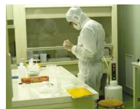
ICP質量分析室。クリーンルーム内で微量金属元素の分析を行う
