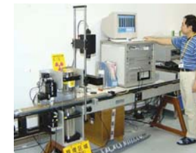
マルチセンサーコアローガー。密度を調べるガンマ線透過率センサーなど5つの物性センサーにより、非破壊で連続自動測定を行う
