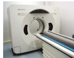
CTスキャナ。掘削コアの内部構造を非破壊のまま調べる
