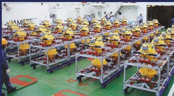
海溝型地震の発生メカニズムを明らかにするため、地下構造探査に用いられる海底地震計
