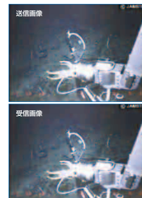
図5 32-QAMを用いた実海域音響通信実験の結果 送信した画像がエラーなく再現されている
