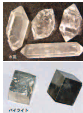
上は常圧常温で安定なシリカ鉱物である石英の六角柱状結晶(水晶)。下はパイライト(二硫化鉄)のサイコロ型結晶。超高温高温環境下では、シリカもこのような結晶となる
