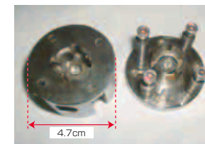
「ダイヤモンドアンビル装置」。超高压高温状態を発生できるのは、中心部のわずか数十マイクロメートルほどの領域に限られる
