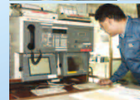
海底地震計(左上)の標識ブイの信号には、いまでもモールス符号が使われている。かつて電信の時代に活躍した電鍵(上)。通信士に替わって安全な航行に欠かせない情報を受信し、遭難を知らせるGMDSS機器(左)
