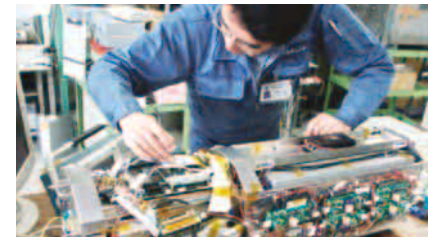
自律型無人探査機への搭載をめざして開発が進められているマルチCPUシステム。新たな探査機の実現には高精度な電子制御技術の開発が欠かせない
