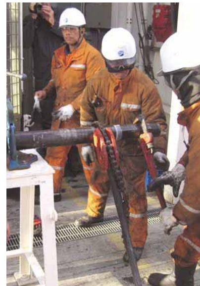
ピストン式コアバレルによって採取され、船上に回収されたコア試料
