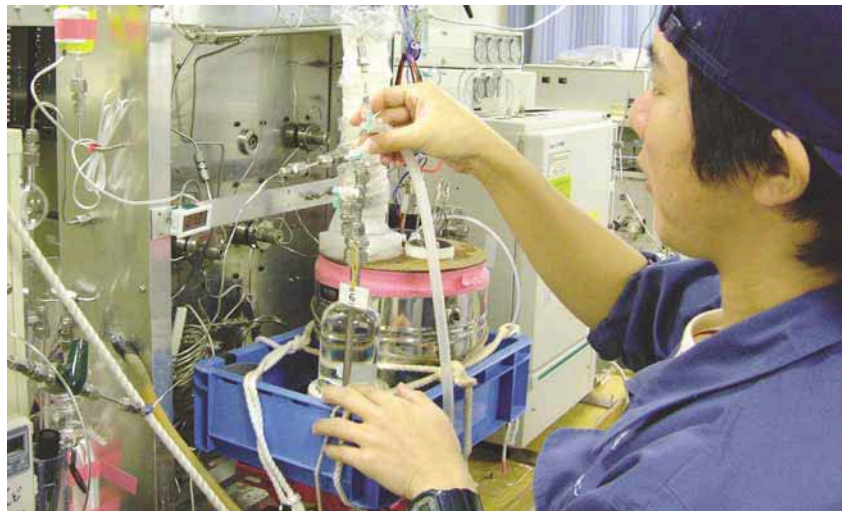
フロン類前処理装置に、採取した海水試料を導入する様子
