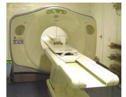
X線CTスキャナーで採取されたコア試料の内部構造を調べる
