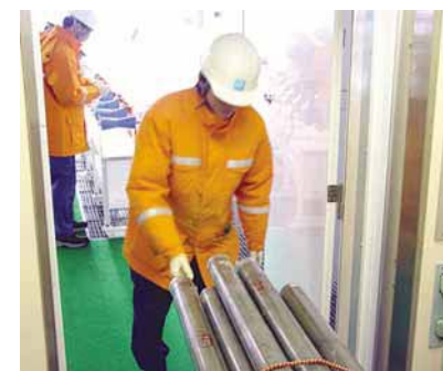
コア切断エリアで1.5mに切断され、運ばれるコア試料
