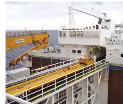
採取されたコア試料は、ドリルフロアから研究区画（右）に移送される
