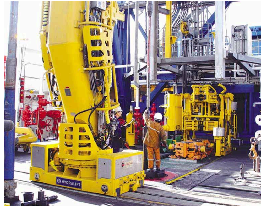
ドリルフロアで行われるドリルパイプの接続作業の様子。作業はすべて自動化されており、ラフネックと呼ばれる作業員は、機器の動作確認などサポート的な業務を行う
