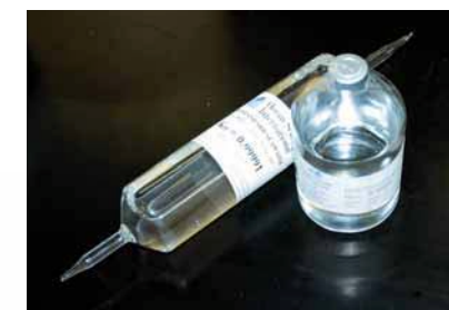
塩分の測定に欠かせない標準海水。塩化カリウム標準液に対して計測された電気伝導度比が記載されている
