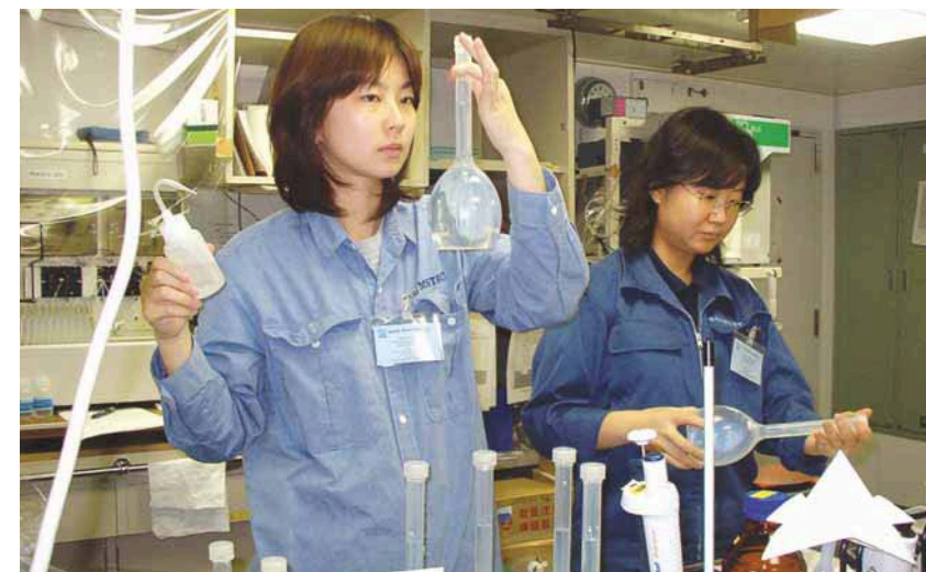
栄養塩分析に使用する標準溶液を調整しているところ
