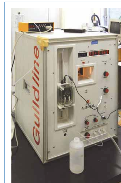
塩分を測定するサリノメータの代表的な機器「オートサル」
