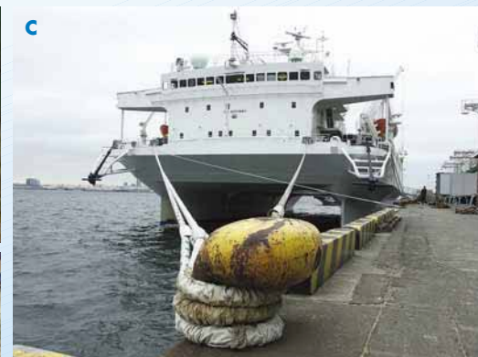
(写真A) 様々なロープ。右から3番目がアイ・スプライス (写真B) この程度のナイロンロープなら新品で約200トンの力に耐える。「しんかい6500」もロープを使えば船体を痛めずに吊り上げられる (写真C) 山下ふ頭にて停泊中の「かいよう」。この巨体を繋ぎとめているのは前後8本のロープだけだ (写真D) 「キング・オブ・ノット」、もやい結び。結び目がほどけず、右の輪も締まらないのが特徴
