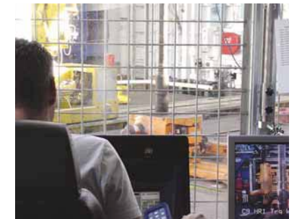
パイプハンドリングの作業機器は、すべてドリルハウスのなかから遠隔操作される
