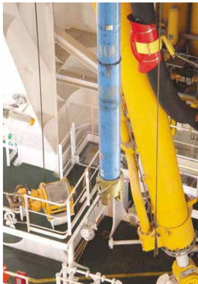
コア採取試験でコアビット、コアバレルなどを接続したパイプを海中に降下させる様子
