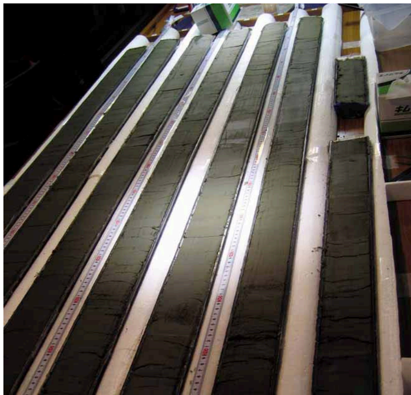
今回の試験運用において「ちきゅう」で初めて採取された海底表層のコア試料（半裁）
