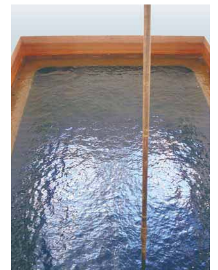
船体の中央に開けられたムーンプールからドリルパイプを海中に降下する
