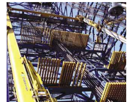
ドリルパイプ4本を連結し、デリック内のラック(フィンガーボード)に収納
