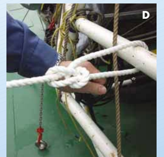
(写真A) 様々なロープ。右から3番目がアイ・スプライス (写真B) この程度のナイロンロープなら新品で約200トンの力に耐える。「しんかい6500」もロープを使えば船体を痛めずに吊り上げられる (写真C) 山下ふ頭にて停泊中の「かいよう」。この巨体を繋ぎとめているのは前後8本のロープだけだ (写真D) 「キング・オブ・ノット」、もやい結び。結び目がほどけず、右の輪も締まらないのが特徴
