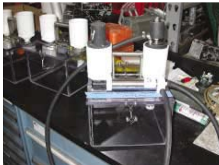
シロウリガイの成長速度を測定するために、このケージを現場でシロウリガイにかぶせた後、内部に高濃度のストロンチウムと蛍光色素を注入する。それをシロウリガイが取り込み、貝殻にマーキングされる。ケージの手前に取り付けたより戻し状金属物が、Galvanic Timed Releaseと呼ばれる電食式リリーサ
