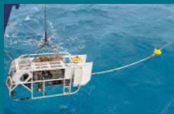
海底電気探査を行う「ディープ・トウ」
