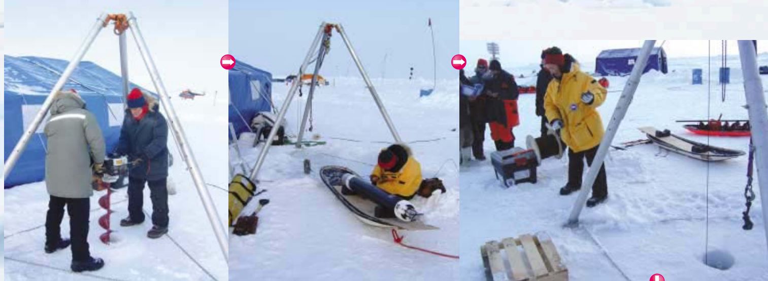
図5 設置の手順。氷に穴を開け、おもりとアルゴフロートをつけたケーブルを三脚を用いて手動で繰り出していく。氷上にはプラットフォームを設置して終了
