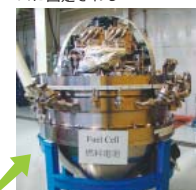
図3 整備作業中の「うらしま」と閉鎖式燃料電池システム
