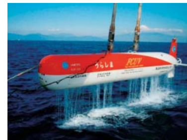
図1 支援母船に回収作業中の深海巡航探査機「うらしま」 2005年には燃料電池を搭載した自律型無人探査機として世界記録となる317kmの連続自律航行を達成した
