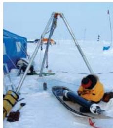
氷海観測用 プロファイラー (POPS)の設置 アルゴフロートを利用した 漂流ブイにより海水温、塩 分濃度、気温、気圧、ブイ の漂流速度を観測する
