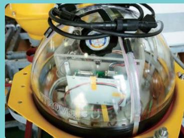
海底地震計。耐圧容器のなかに地震計や電源が詰め込まれている
