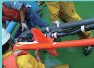
ストリーマーカープルの取り付けられた「バード」。羽の角度を変えることにより、ケーブルの深度を変えることができる
