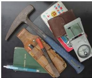
調査用具。左から、ペン、野帳、蛍光マーカー、たがね、ハンマー、色鉛筆、クリノコンパス(方位磁石と水準器)、走向板(アクリル板で代用)
