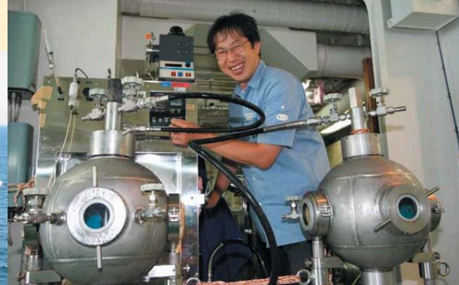
深海から引き上げられたディープアクアリウムを、維持装置に取り付ける三輪GL。生物へのダメージを抑えるため、一刻を争う作業だ。維持装置によって、新鮮な海水を循環させながら、水深2,000mに相当する20MPaまで加圧することができる
