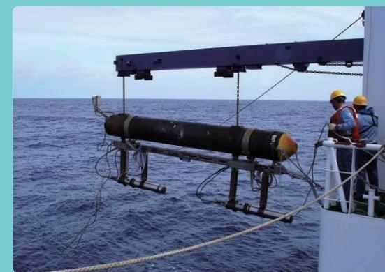
人工地震を起こすエアガン。JAMSTECでは地下構造探査により適したきれいな波形を発生できるエアガンを、2008年度から導入する予定
