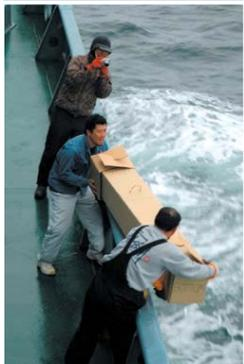
南大洋に投入されるアルゴフロート。ロープでつり下げて投入する以外に、段ボールで梱包したまま投入する方法もある。段ボールが緩衝材になるので、船舶を完全に停止させなくても投入が可能だ。投入方法を簡単にすることで、多くの船舶に協力してもらうことを目指している。段ボールは数十分で水に溶けてしまう（写真提供：日本鯨類研究所）
