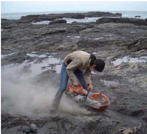
野外のサンプリング風景(宮崎県延岡地域)。壊れやすく採取が困難な岩石試料は、樹脂で固めてカッターで切り出す。「この写真は後輩です。男性が多い分野ですが、女性も頑張っていますよ」
