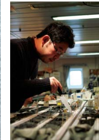
生きている地層、コアのサンプリング。掘削で得られた円柱状のコアの半分は高知コア研究所などで保存され、半分が船上の研究者などの研究用に使われる
