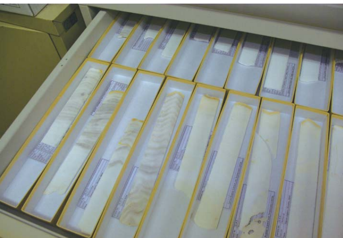
実験室に保管されているサンゴの骨格標本。直径3cmほどの柱状の試料を縦に切ったもの。うっすらと見えるしま模様は年輪。骨格を先端から削っていき、その粉末に含まれる酸素や炭素の同位体比を分析する
