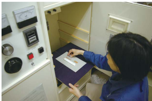
サンゴの骨格標本のX線撮影の様子。肉眼では年輪の一部しか確認できないが、X線写真では密度の違いから濃淡のしま模様鮮明に浮き上がる
